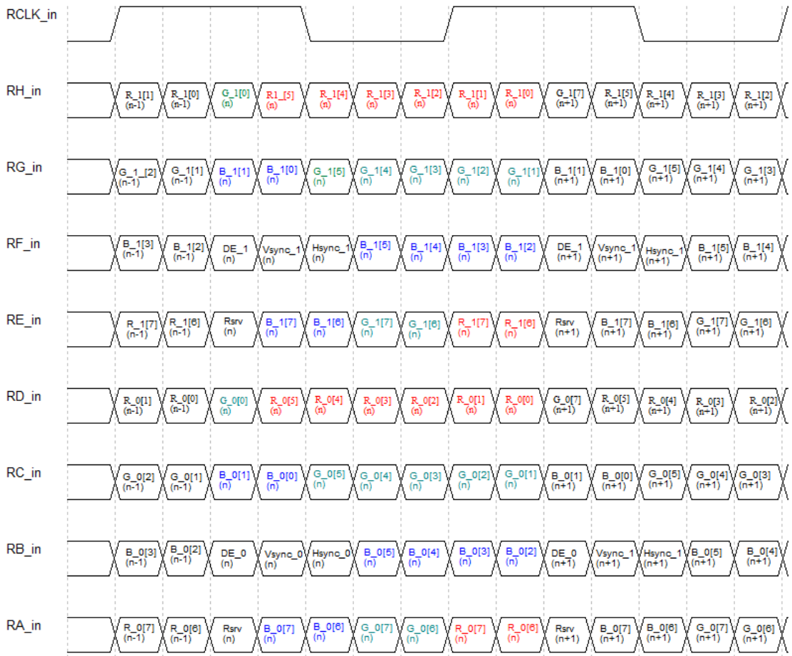
图 6-1 LVDS7:1 接收到 LVDS4:1 桥接输入信号时序
