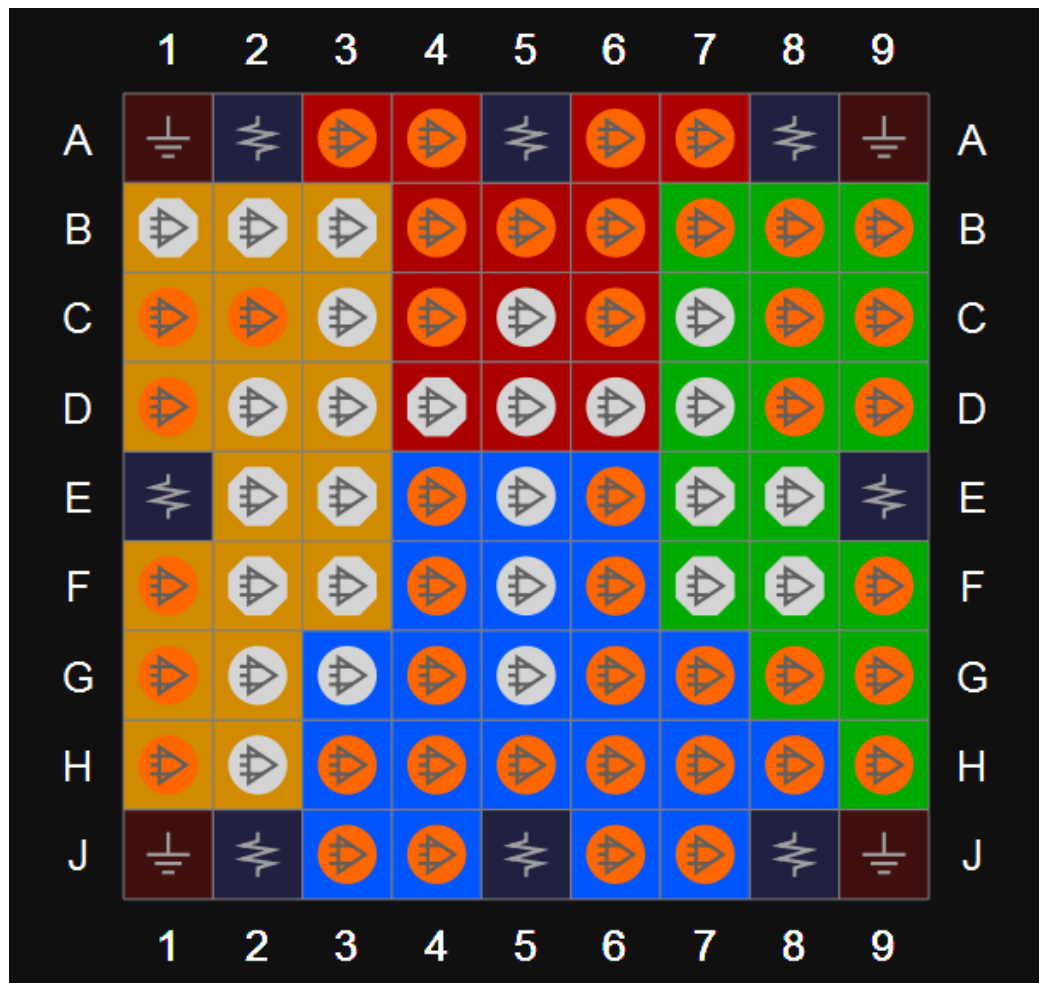
图 3-2 GW1NR-4 器件 MG81 封装管脚分布示意图（顶视图）
