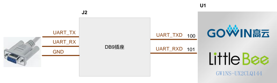
图 3-13 RS232 下载连接示意图
