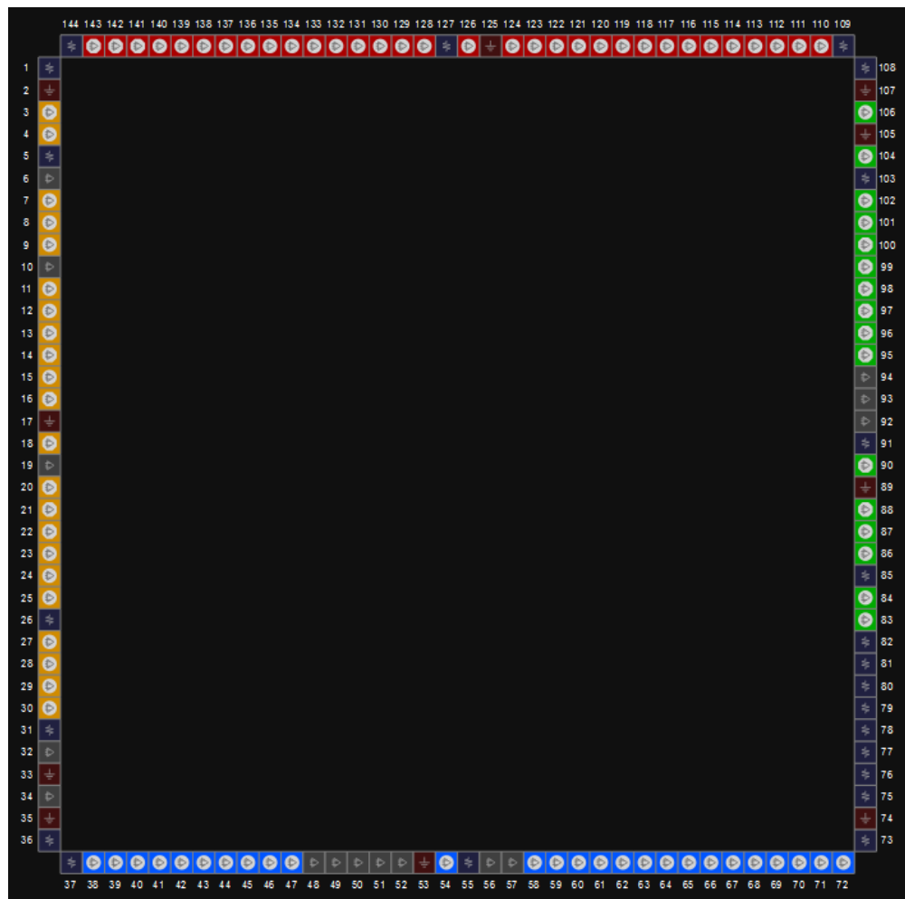
图 3-2 LQ144 封装管脚分布示意图（顶视图）
