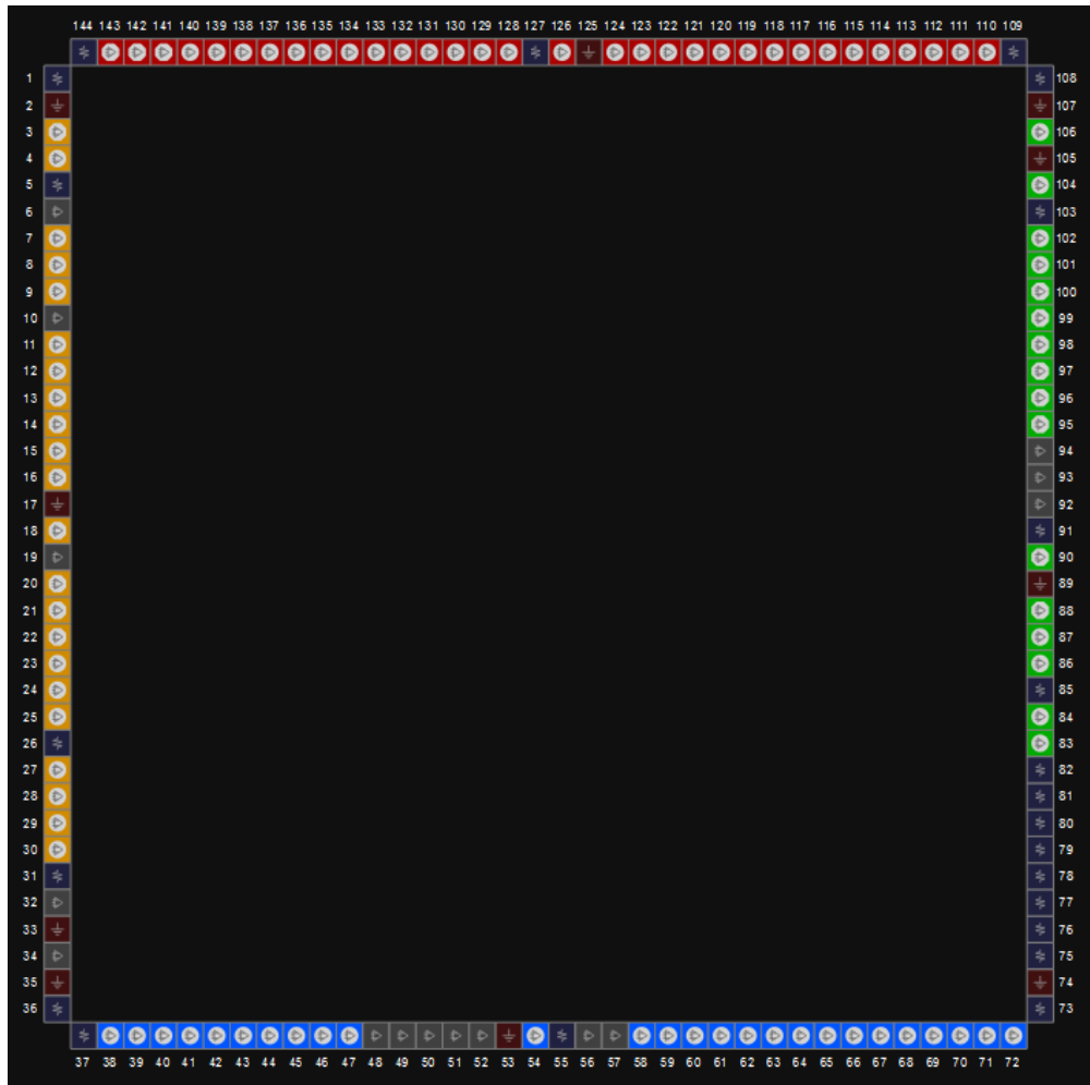
图 3-2 LQ144 封装管脚分布示意图（顶视图）
