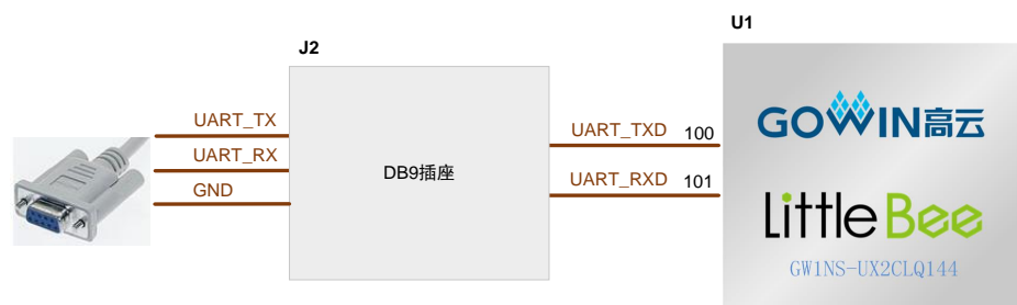
图 3-13 RS232 下载连接示意图
