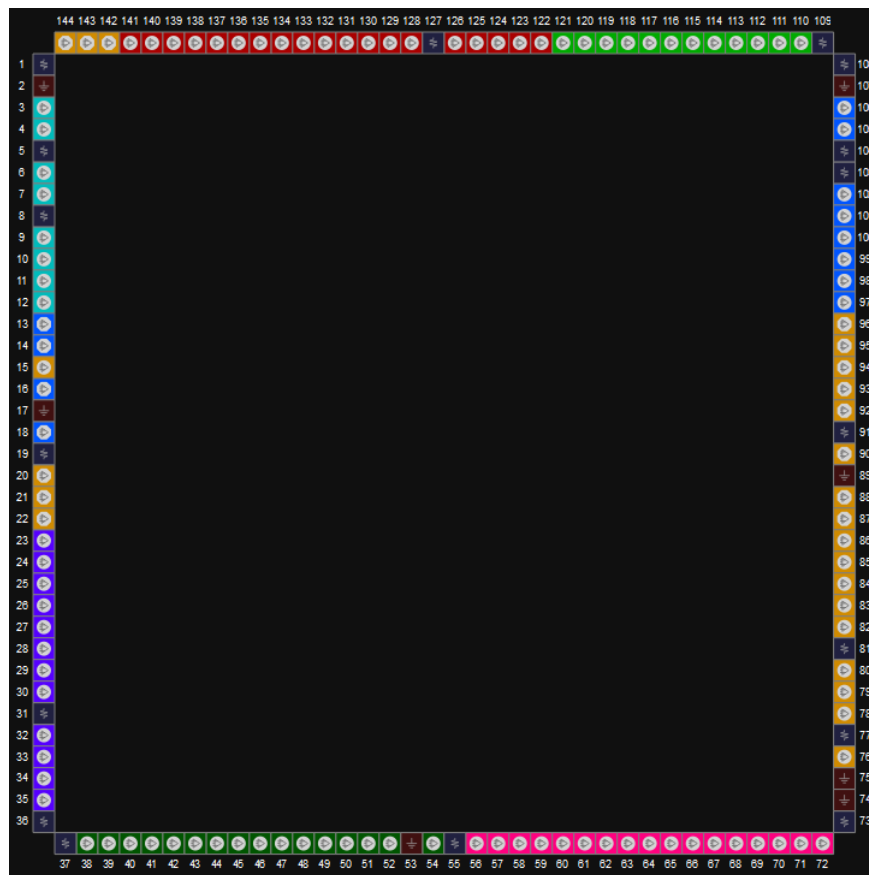
图 3-2 GW2AR-18 器件 EQ144 封装管脚分布示意图（顶视图）
