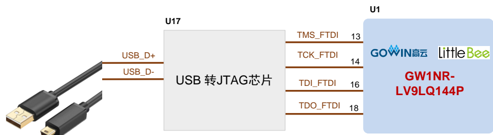
图 3-3 FPGA USB 下载连接示意图
