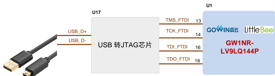
图 3-3 FPGA USB 下载连接示意图
