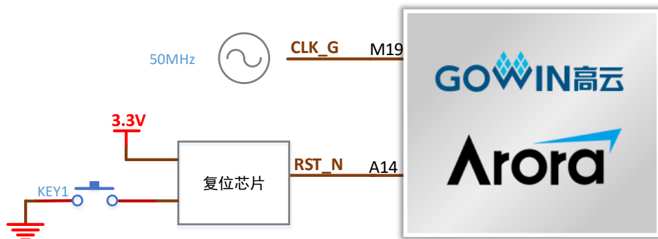
图 3-5 时钟、复位连接示意图
