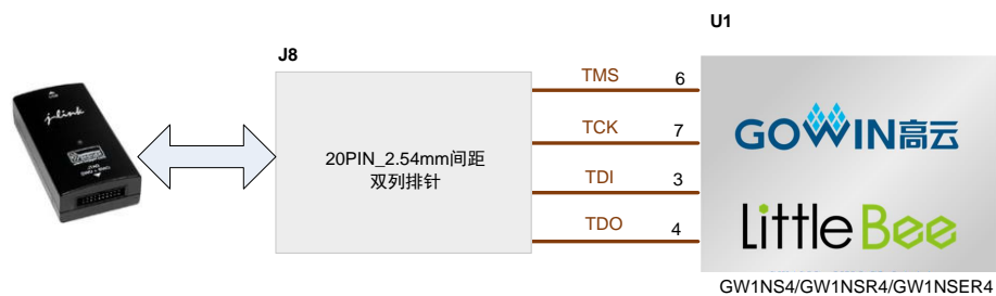
图 3-2 FPGA J-Link 连接示意图
