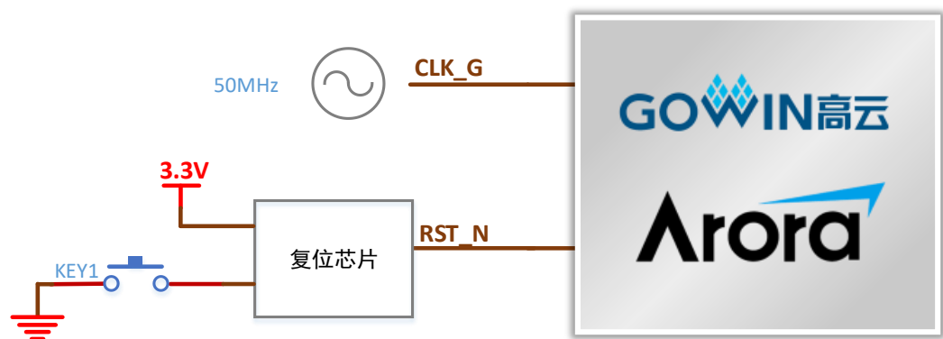
图 3-2 时钟、复位连接示意图
