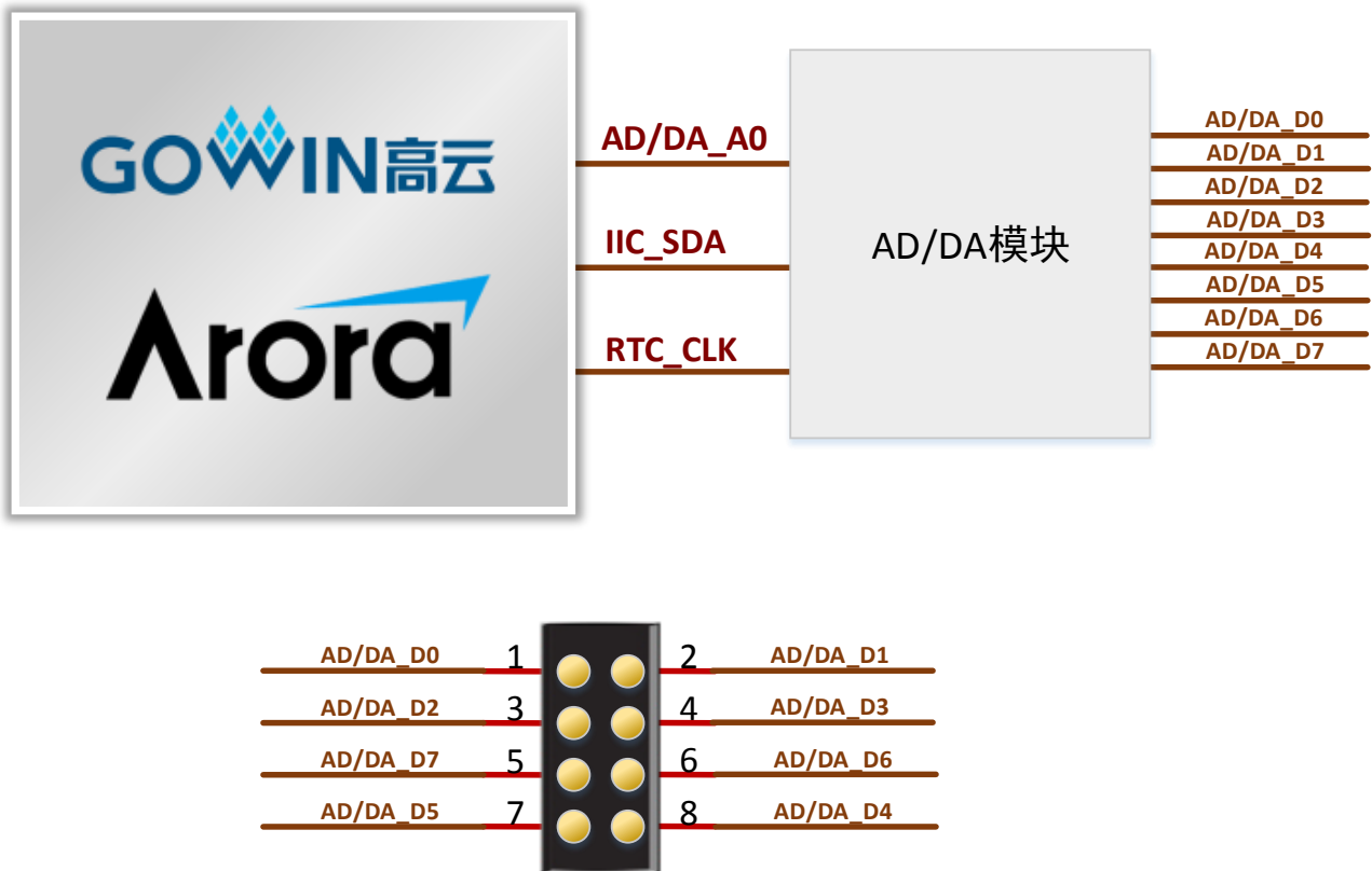
图 3-11 AD/DA 模块连接示意图
