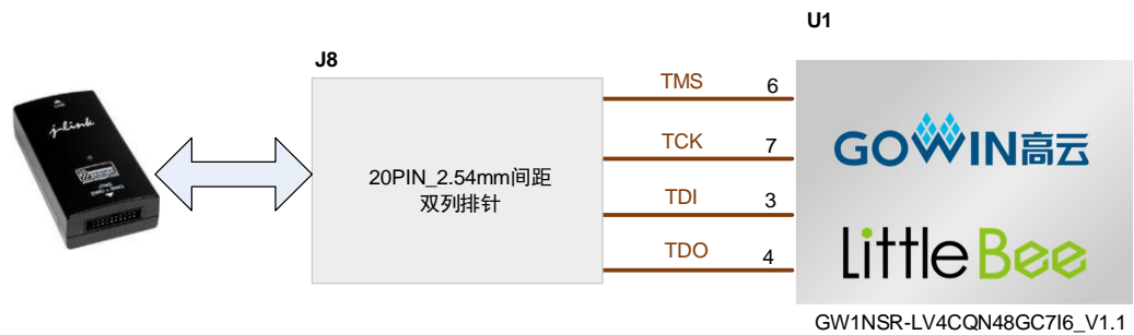
图 3-2 FPGA J-Link 连接示意图
