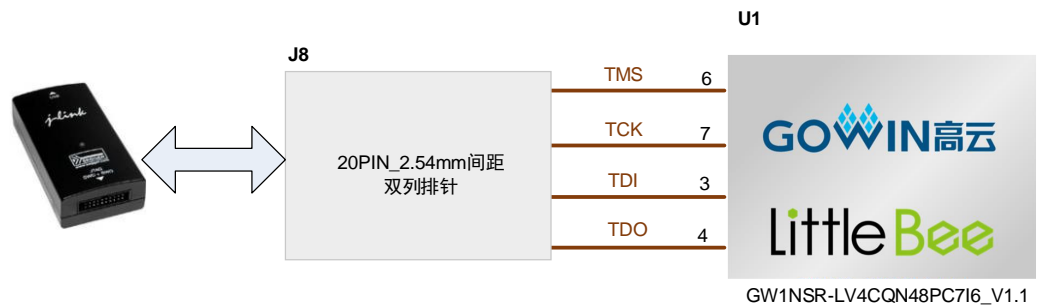
图 3-2 FPGA J-Link 连接示意图
