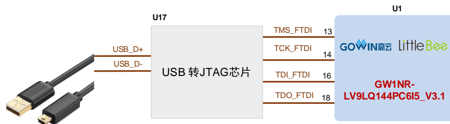
图 3-1 FPGA USB 下载连接示意图
