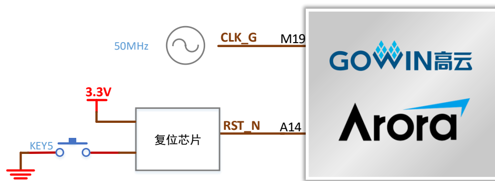
图 3-3 时钟、复位连接示意图
