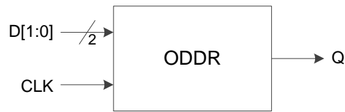
图 3-17 I/O 逻辑的 DDR 输出示意图
