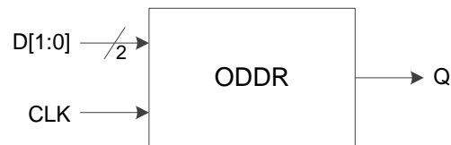
图 3-18 I/O 逻辑的 DDR 输出示意图
