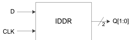
图 3-17 I/O 逻辑的 DDR 输入示意图
