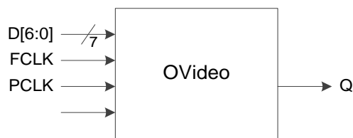
图 3-23 I/O 逻辑的 OVideo 输出示意图
