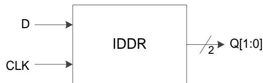
图 3-18 I/O 逻辑的 DDR 输入示意图
