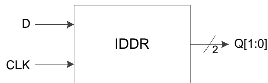
图 3-18 I/O 逻辑的 DDR 输入示意图
