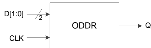
图 3-19 I/O 逻辑的 DDR 输出示意图
