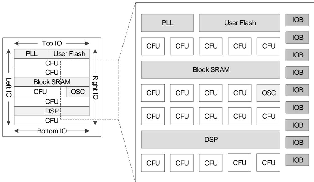
图 3-2 GW1N 系列 FPGA 器件结构示意图 (GW1N-2)
