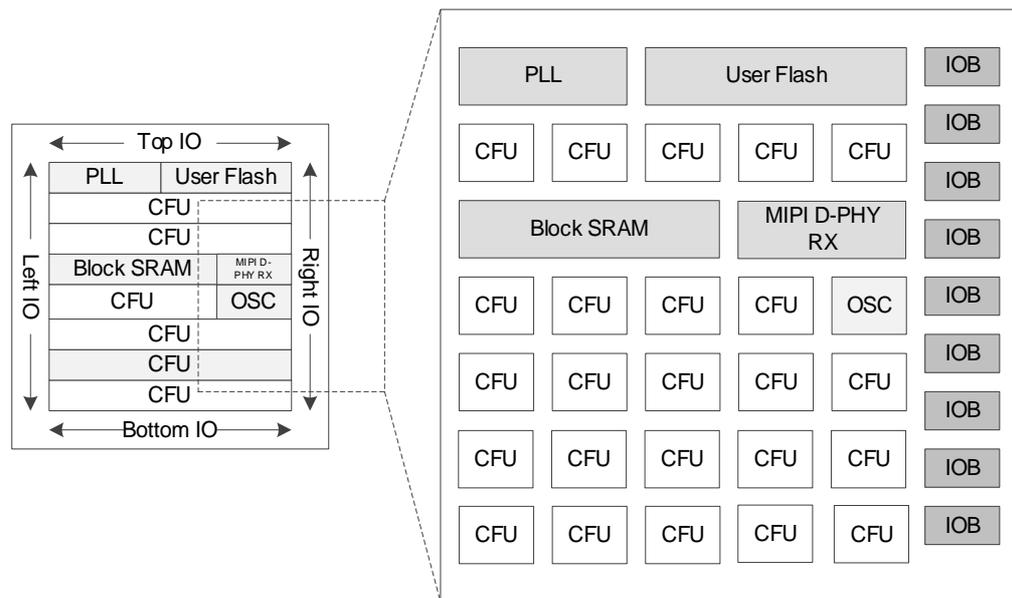
图 3-1 为 GW1N 系列 FPGA 器件结构示意图，器件内部是一个逻辑单元阵列，外围是输入输出模块(IOB)，器件内嵌了静态随机存储器 (BSRAM) 模块、数字信号处理模块 DSP、PLL 资源、片内晶振和用户闪存资源 User Flash，支持瞬时启动功能。图 3-2 为 GW1N-2 器件结构示意图，在 GW1N 系列其他器件的基础上内嵌了 MIPI D-PHY RX 硬核模块。内部资源数量详细信息请参见表 2-1。
