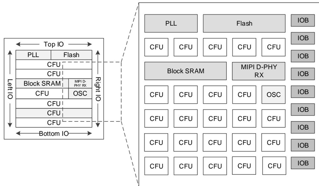
图 2-1~图 2-3 为 GW1N 系列 FPGA 器件结构示意图，器件内部是一个逻辑单元阵列，外围是输入输出模块(IOB)，器件内嵌了静态随机存储器（BSRAM）模块、数字信号处理模块 DSP、PLL 资源、片内晶振和闪存资源，支持瞬时启动功能。图 2-4 为 GW1N-2 器件结构示意图，在 GW1N 系列其他器件的基础上内嵌了 MIPI D-PHY RX 硬核模块。内部资源数量详细信息请参见表 1-1。
