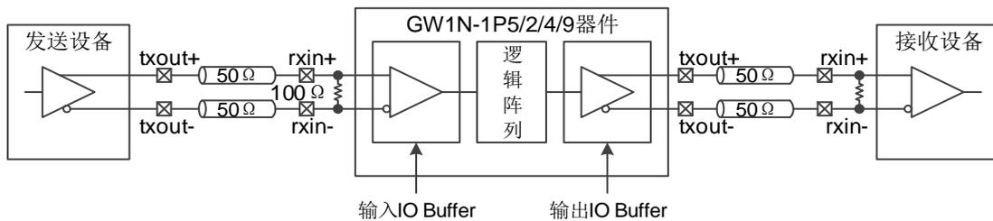
LVDS25E、MLVDS25E、BLVDS25E 等差分 I/O 终端匹配电阻网络请参见 [UG289, Gowin 可编程通用管脚 \(GPIO\) 用户指南](#)。
