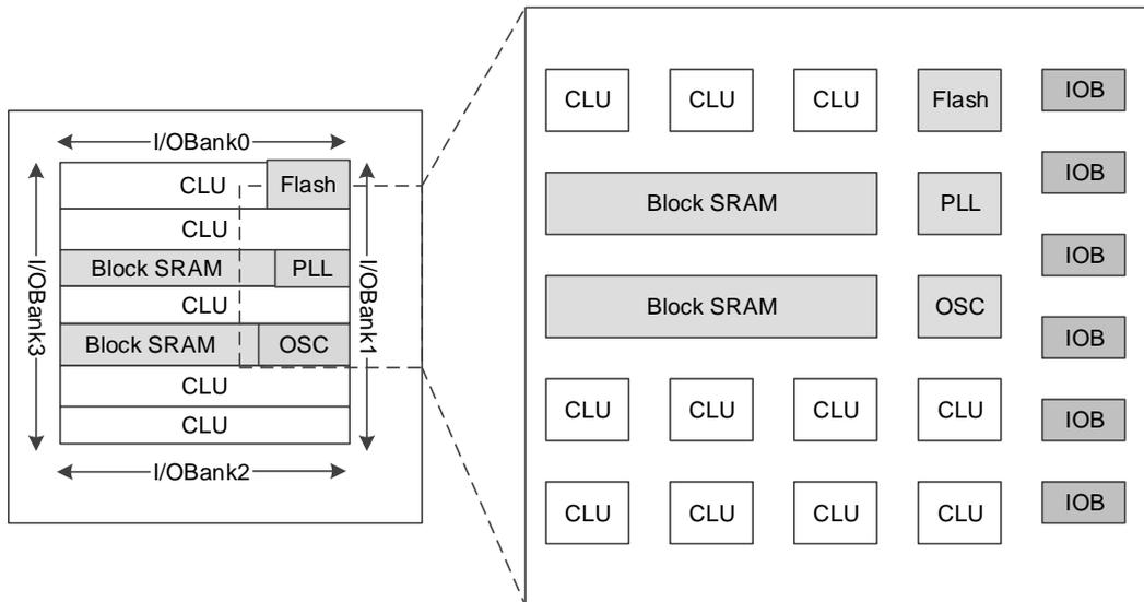
图 2-4 GW1N 系列 FPGA 器件结构示意图 (GW1N-2)
