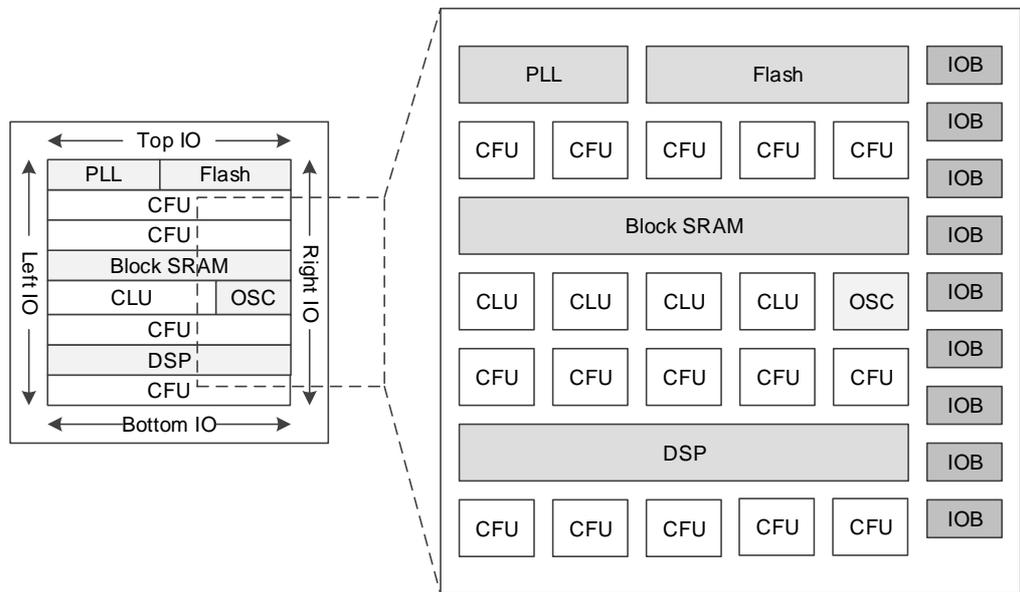
图 2-2 GW1N 系列 FPGA 器件结构示意图 (GW1N-4)
