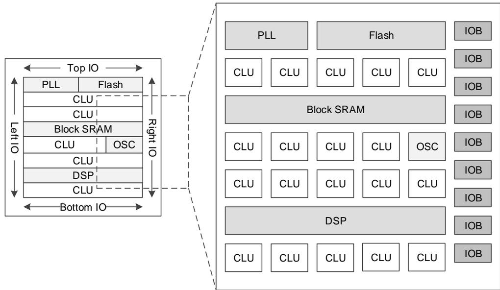
图 2-3 GW1N 系列 FPGA 器件结构示意图 (GW1N-1)
