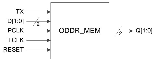
图 3-24 IO 逻辑的 ODDR_MEM 输出示意图
