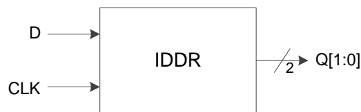
图 3-13 I/O 逻辑的 DDR 输入示意图
