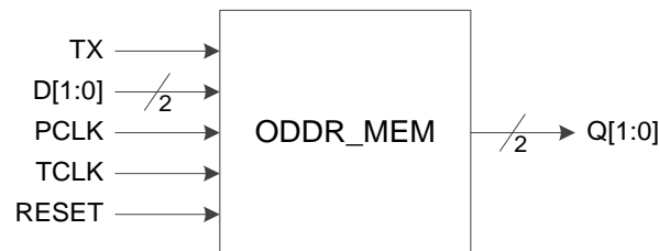
图 3-24 IO 逻辑的 ODDR_MEM 输出示意图
