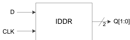
图 3-13 I/O 逻辑的 DDR 输入示意图
