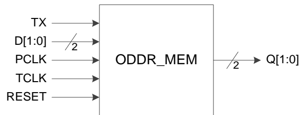
图 3-24 IO 逻辑的 ODDR_MEM 输出示意图
