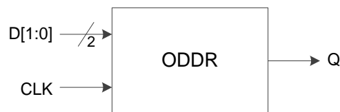
图 3-14 I/O 逻辑的 DDR 输出示意图
