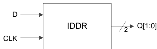
图 3-13 I/O 逻辑的 DDR 输入示意图
