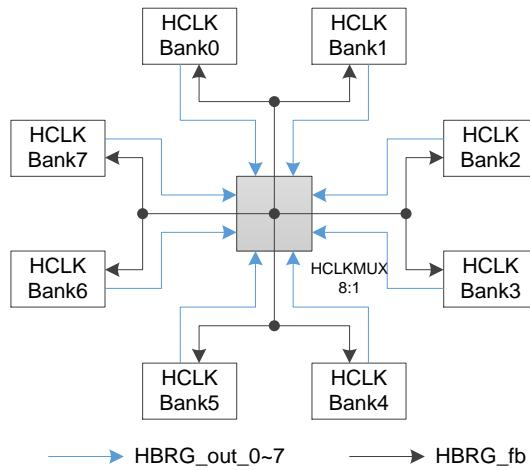
由图 3-46 可以看到，高速时钟 HCLK 的中间有一个 8:1 的 HCLKMUX 模块，HCLKMUX 能将任何一个 Bank 中的 HCLK 时钟信号送到其他任何一个 Bank 中，这使得 HCLK 的使用更加灵活。
