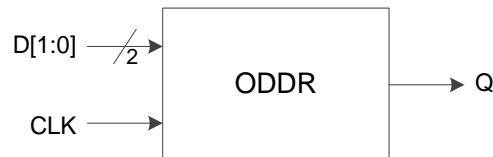
图 3-14 I/O 逻辑的 DDR 输出示意图
