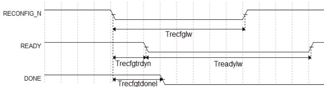
图 4-4 MSPI 编程模式时序示意图
