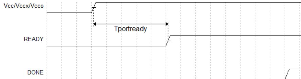
图 4-3 GW2A RECONFIG\_N 触发时序图
