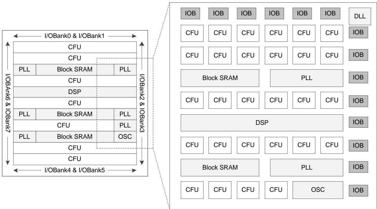
图 3-1 为 GW2A 系列 FPGA 产品结构示意图，GW2A-18/GW2A-18C 和 GW2A-55/GW2A-55C 器件内部资源数量详细资料请参考表 2-1。器件内部是一个逻辑单元阵列，外围是输入输出模块( IOB )，器件内嵌了静态随机存储器 ( B-SRAM ) 模块、数字信号处理模块 DSP 、 PLL 资源、 DLL 资源和片内晶振。
