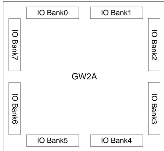
GW2A 系列 FPGA 产品不同的 Bank 支持不同的片上电阻设置, 包括单端电阻和差分电阻两种。单端电阻设置用于 SSTL/HSTL 输入输出, 在 Bank2/3/6/7 中支持。差分电阻设置用于 LVDS 输入, 仅在 Bank0/1 中支持。详细资料请参考 [《Gowin 系统管脚 \(systemIO\) 用户指南》](#)。
