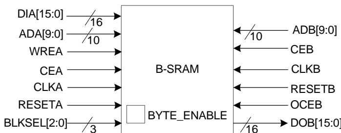
图 3-32 伪双端口存储模式框图 2
