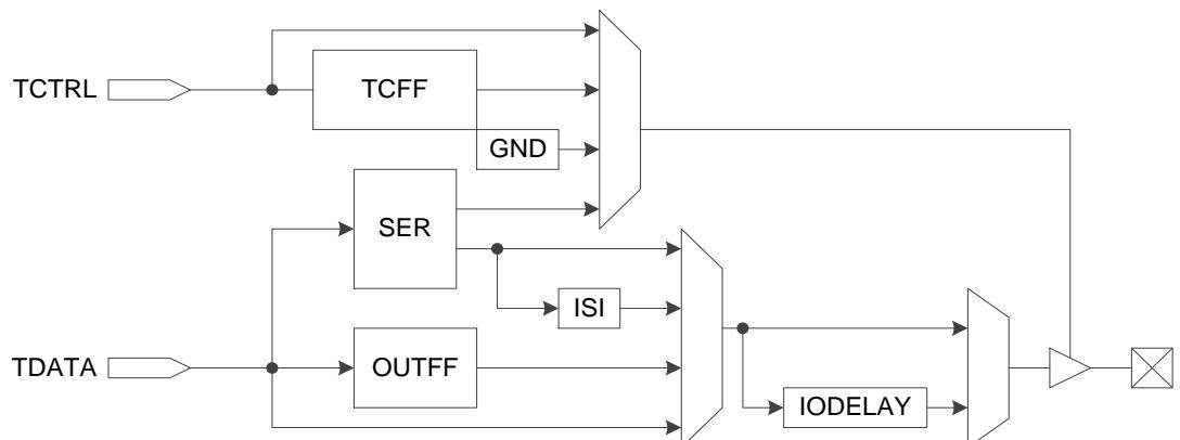
图 3-7 为 GW2A 系列 FPGA 产品的 I/O 逻辑的输入部分。
