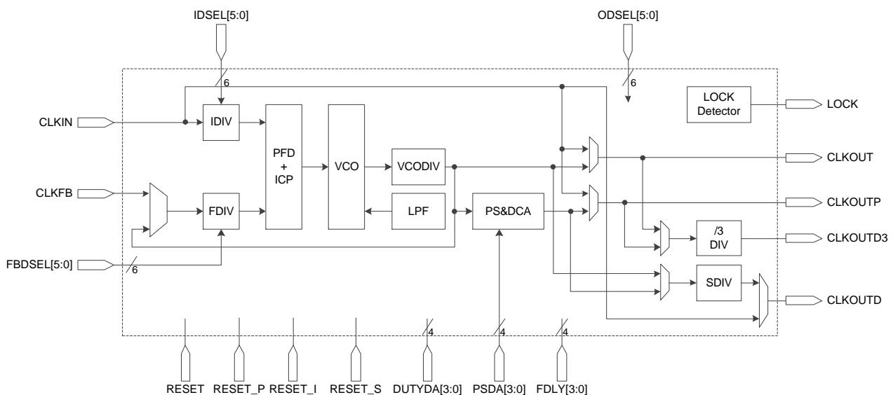
PLL 的参考时钟信号可以通过外部 PLL 时钟管脚输入，也可以是通过绕线过去的全局时钟信号、高速时钟信号或普通数据信号。PLL 的反馈信号可以是外部 PLL 反馈信号的管脚的输入，也可以是通过绕线过去的全局时钟信号、高速时钟信号或普通数据信号。
