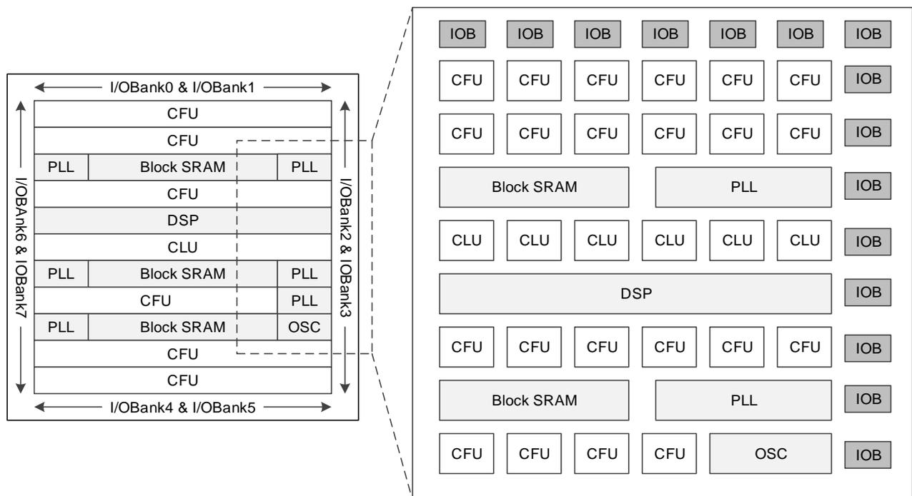
图 2-1 为 GW2A 系列 FPGA 产品结构示意图，GW2A-18 和 GW2A-55 器件内部资源数量详细资料请参考表 1-1。器件内部是一个逻辑单元阵列，外围是输入输出模块(IOB)，器件内嵌了静态随机存储器 (BSRAM) 模块、数字信号处理模块 DSP、PLL 资源和片内晶振。
