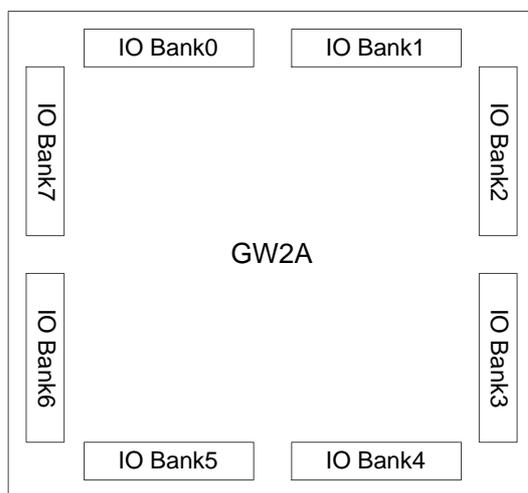
GW2A 系列 FPGA 产品不同的 Bank 支持不同的片上电阻设置, 包括单端电阻和差分电阻两种。单端电阻设置用于 SSTL/HSTL 输入输出, 在 Bank2/3/6/7 中支持。差分电阻设置用于 LVDS 输入, 仅在 Bank0/1 中支持, Bank0/1 支持 100 欧姆差分匹配电阻, 详见 [UG289, Gowin 可编程通用管脚\(GPIO\)用户指南](#)。
