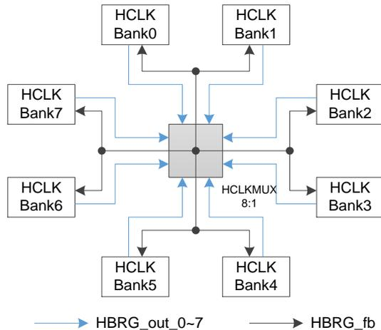
由图 2-14 可以看到，高速时钟 HCLK 的中间有一个 8:1 的 HCLKMUX 模块，HCLKMUX 能将任何一个 Bank 中的 HCLK 时钟信号送到其他任何一个 Bank 中，这使得 HCLK 的使用更加灵活。
