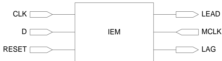
图 3-11 GW1NR 的 IEM 示意图
