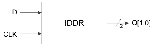
图 3-14 I/O 逻辑的 DDR 输入示意图
