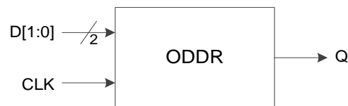
图 3-15 I/O 逻辑的 DDR 输出示意图
