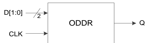
图 3-15 I/O 逻辑的 DDR 输出示意图
