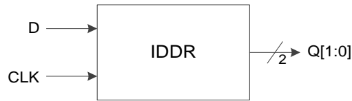
图 3-14 I/O 逻辑的 DDR 输入示意图
