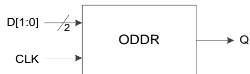
图 3-15 I/O 逻辑的 DDR 输出示意图
