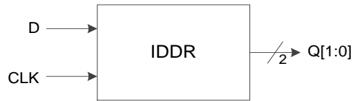
图 3-14 I/O 逻辑的 DDR 输入示意图
