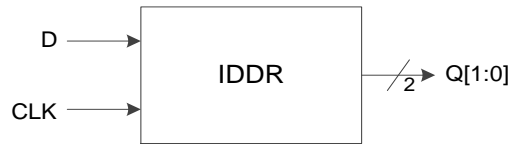
图 3-16 I/O 逻辑的 DDR 输入示意图
