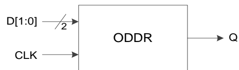
图 3-17 I/O 逻辑的 DDR 输出示意图
