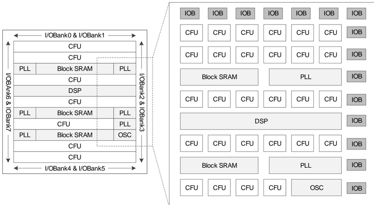
图 3-1 为 GW2A 系列 FPGA 产品(车规级)结构示意图，GW2A-18 器件内部资源数量详细资料请参考表 2-1。器件内部是一个逻辑单元阵列，外围是输入输出模块(IOB)，器件内嵌了静态随机存储器 (B-SRAM) 模块、数字信号处理模块 DSP、PLL 资源和片内晶振。
