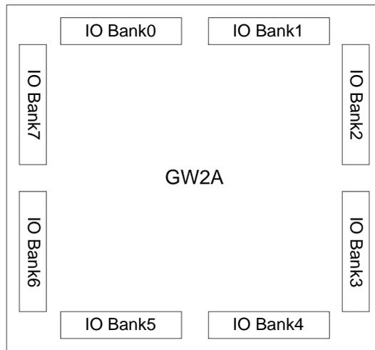
GW2A 系列 FPGA 产品(车规级)不同的 Bank 支持不同的片上电阻设置,包括单端电阻和差分电阻两种。单端电阻设置用于 SSTL/HSTL 输入输出,在 Bank2/3/6/7 中支持。差分电阻设置用于 LVDS 输入,仅在 Bank0/1 中支持。详细资料请参考 [UG289, Gowin 可编程通用管脚 \(GPIO\) 用户指南](#)。
