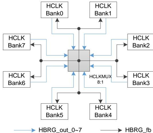
由图 3-41 可以看到，高速时钟 HCLK 的中间有一个 8:1 的 HCLKMUX 模块，HCLKMUX 能将任何一个 Bank 中的 HCLK 时钟信号送到其他任何一个 Bank 中，这使得 HCLK 的使用更加灵活。
