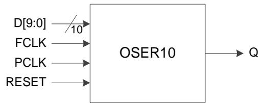
GW2A 系列 FPGA 产品(车规级)支持带 memory 的 IO 接口模式，支持双倍/四倍/八倍速率输入和输出，包括 IDDR\_MEM/IDES4\_MEM/IDES8\_MEM 和 ODDR\_MEM/OSER4\_MEM/OSER8\_MEM 模式。
