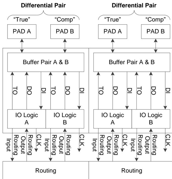
GW2A 系列 FPGA 产品(车规级)中 IOB 的功能特点:
