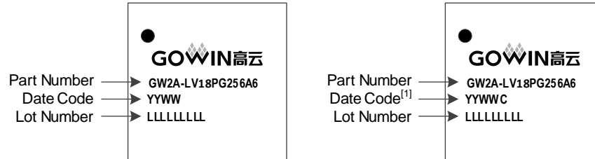
图 5-2 器件封装标识示例
