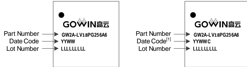
图 5-2 器件封装标识示例
