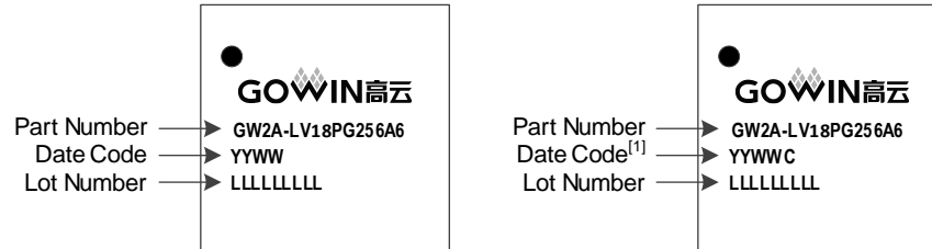
图 5-2 器件封装标识示例
