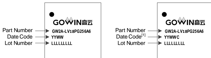
图 5-2 器件封装标识示例
