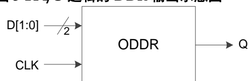
图 3-14 I/O 逻辑的 DDR 输出示意图
