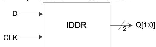
图 3-13 I/O 逻辑的 DDR 输入示意图
