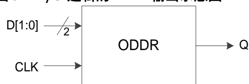
图 3-14 I/O 逻辑的 DDR 输出示意图
