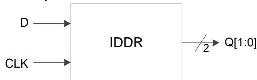
图 3-13 I/O 逻辑的 DDR 输入示意图
