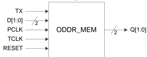
图 3-24 IO 逻辑的 ODDR_MEM 输出示意图
