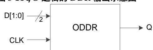
图 3-14 I/O 逻辑的 DDR 输出示意图
