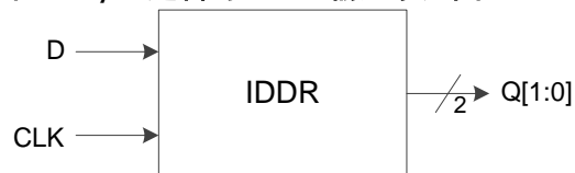
图 3-13 I/O 逻辑的 DDR 输入示意图
