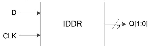
图 3-13 I/O 逻辑的 DDR 输入示意图
