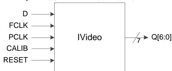
图 3-17 I/O 逻辑的 IVideo 输入示意图
