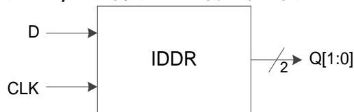
图 3-13 I/O 逻辑的 DDR 输入示意图
