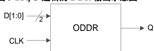
图 3-14 I/O 逻辑的 DDR 输出示意图
