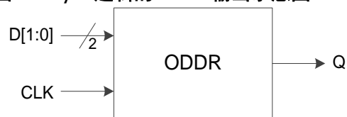
图 3-14 I/O 逻辑的 DDR 输出示意图
