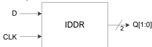
图 3-13 I/O 逻辑的 DDR 输入示意图
