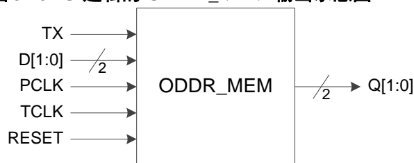
图 3-23 IO 逻辑的 ODDR_MEM 输出示意图
