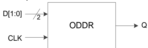
图 3-13 I/O 逻辑的 DDR 输出示意图
