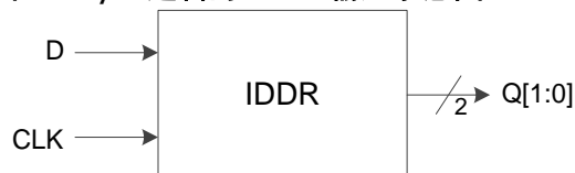
图 3-12 I/O 逻辑的 DDR 输入示意图
