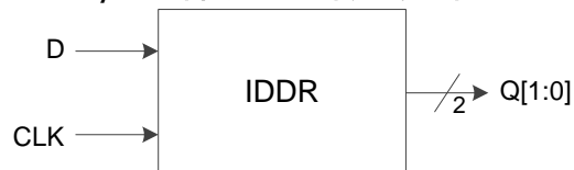
图 3-12 I/O 逻辑的 DDR 输入示意图
