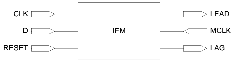
图 3-9 GW2AR 的 IEM 示意图
