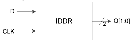
图 3-12 I/O 逻辑的 DDR 输入示意图
