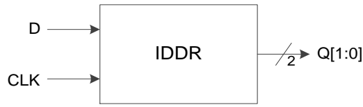
图 3-14 I/O 逻辑的 DDR 输入示意图
