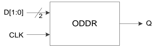
图 3-15 I/O 逻辑的 DDR 输出示意图
