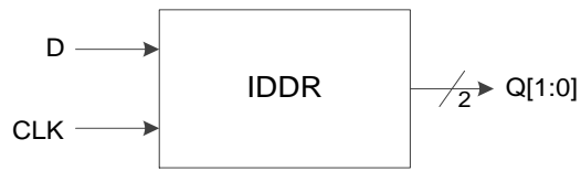
图 3-18 I/O 逻辑的 DDR 输入示意图
