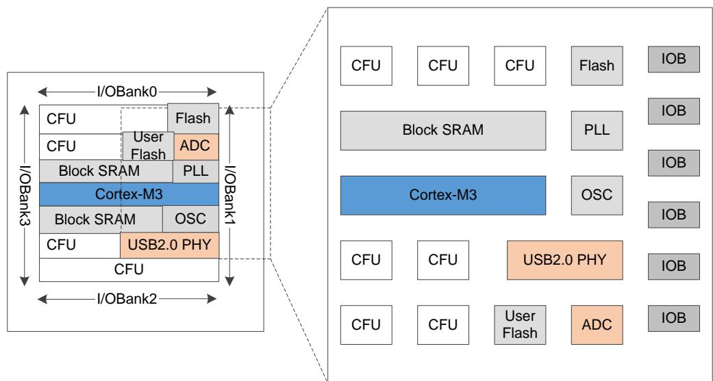
图 3-3 GW1NS-4 器件结构示意图
