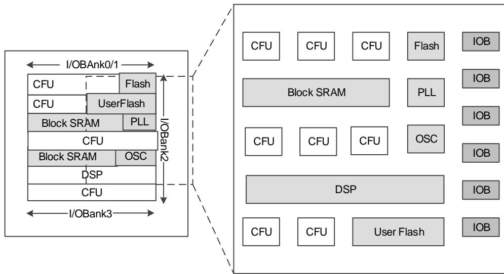
图 3-4 GW1NS-4C 器件结构示意图
