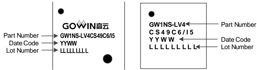
图 5-12 GW1NS-4C 器件封装标识示例
