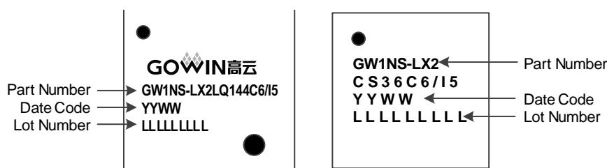
图 5-10 GW1NS-2C 器件封装标识示例
