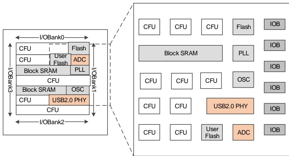
图 3-2 GW1NS-2C 器件结构示意图
