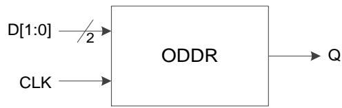
图 3-19 I/O 逻辑的 DDR 输出示意图
