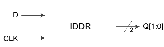
图 3-18 I/O 逻辑的 DDR 输入示意图
