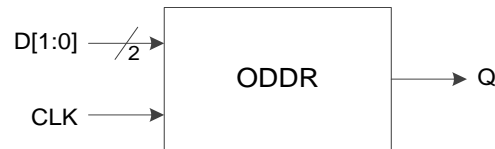
图 3-19 I/O 逻辑的 DDR 输出示意图
